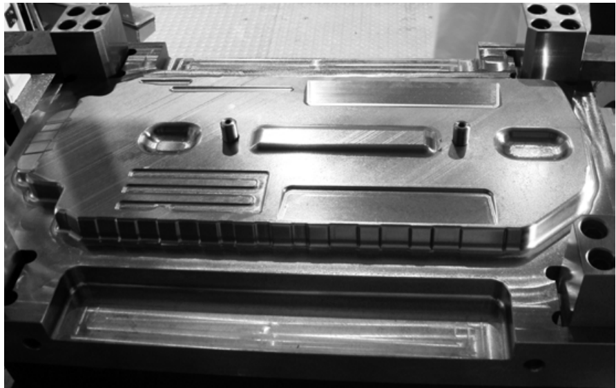
Bild 2. Versuchswerkzeug zum Formschlagen des Demonstrators
