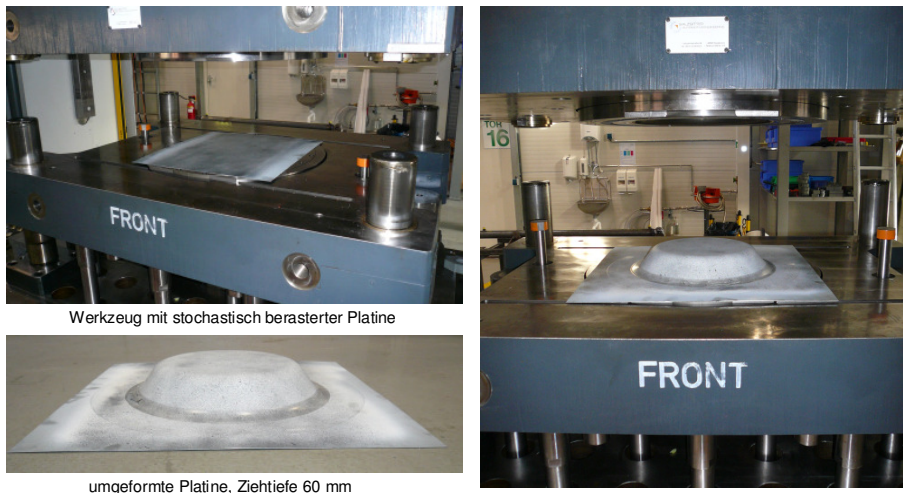
Bild 11: Umformvorgang am modularen Tiefziehwerkzeug
