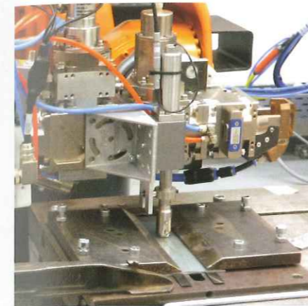
ABBILDUNG 3: Wirbelstromprüfung an Laserschweißnähten.
